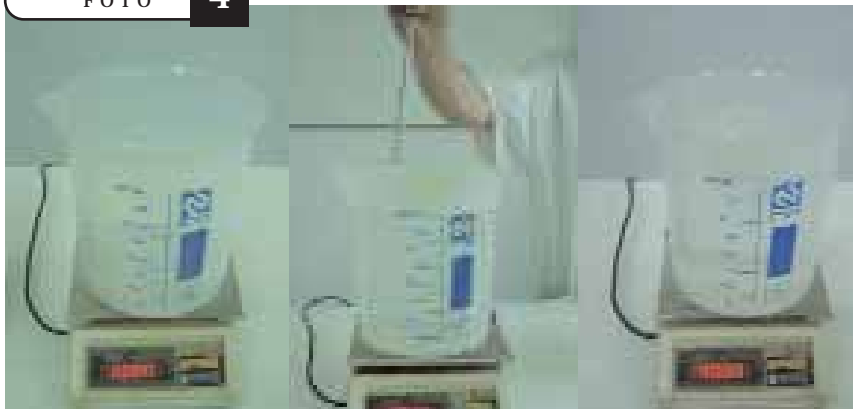
FOTO 4. PESADO DEL FRASCO DE BÉCQUER Y MASA DE 4000 G DE AGUA DESTILADA.
