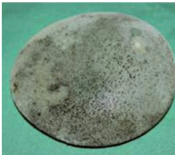
Figura 1. Formación de colonias de microorganismos sobre la cubierta de silicona por exposición prolongada al ambiente.
